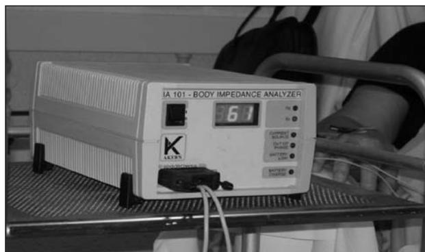
Figura 1: Monitor de bioimpedancia
